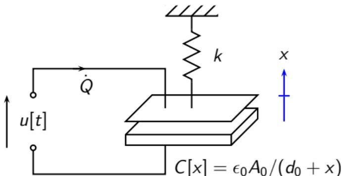
Sustav ima jedan mehanički stupanj slobode (pomak gornje ploče kondenzatora  $x$ ) te jedan električni stupanj slobode (naboj  $Q$ ).
